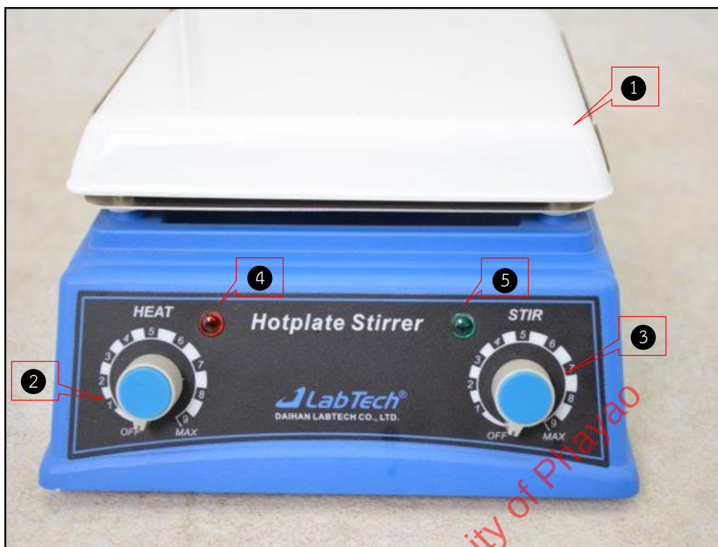
ภาพที่ 3.7 แสดงส่วนประกอบของเครื่องกวนสารละลายพร้อมให้ความร้อน ที่มา: จ่านงค์ เสาวลักษณ์เมฆา. (2569)
