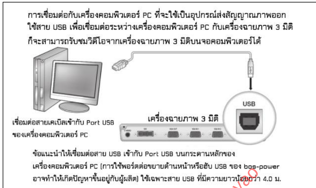
ภาพที่ 60 แสดงการเชื่อมต่อเครื่องคอมพิวเตอร์ PC ในการส่งสัญญาณภาพออกโดยใช้สาย USB เชื่อมต่อเข้ากับ เครื่องฉายภาพ 3 มิติ
