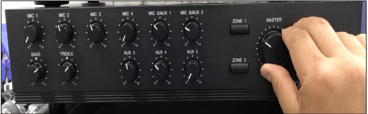
ภาพที่ 31 แสดงการปรับระดับเสียงของเครื่องขยายเสียง
