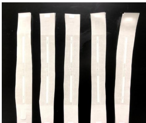
ภาพ 41 Passive Tag ที่ใช้กับคลื่นวิทยุแบบ UHF
